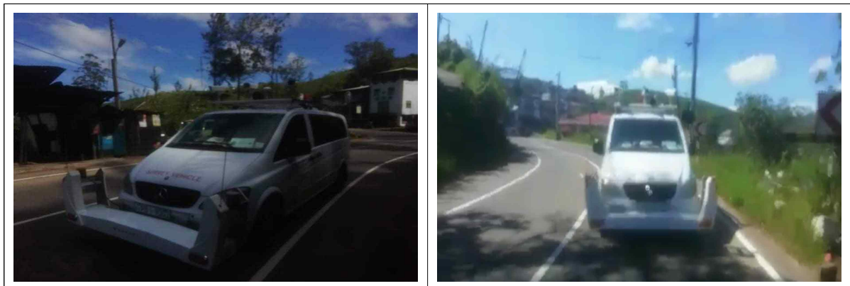
<그림 5> 도로평탄성(IRI) 측정('20.11.08)
